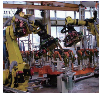
車体溶接設備
