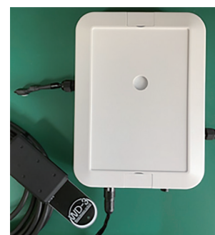
1 台の Box に 温度・湿度・土中水分・CO2 のセンサーを搭載し、LPWA (SIGFOX 等) や 3G 通信にてセンサー情報をクラウドにアップし、WEB 上でグラフやデータ値が確認できるセンサー Box です。
