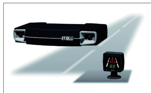
自動車用 衝突防止システムの例
