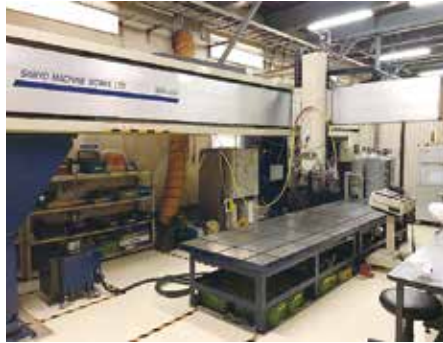
10kw ファイバーレーザと大型テーブル（弊社設備）
