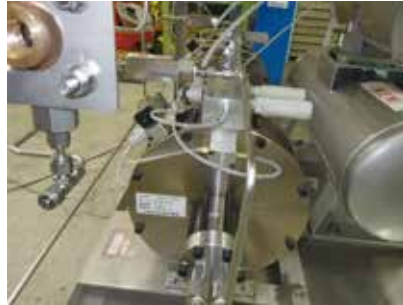
BP-30-30-DC *-DC は、ダブルチェック弁 (H28.9 より製造開始) 圧力保持、耐久性の向上が期待できる
