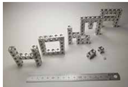
丸棒から作成した六面体のブロック（PR用）
