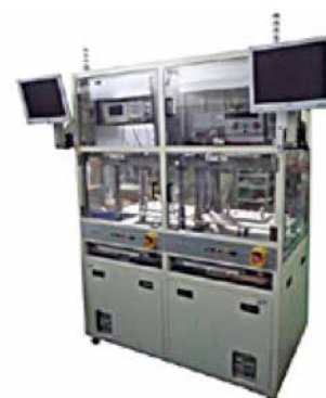
パワーモジュール信頼性評価試験装置 (LCR、絶縁耐圧、絶縁微小VI、微小VI、ICES 印加連続試験、サーミスタ試験等)
