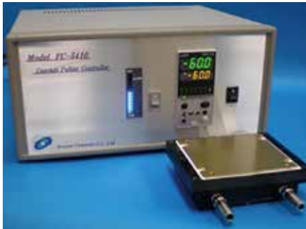
(極低温ペルチェ冷熱プレート) (電源のみで -60°C 提供可能)
