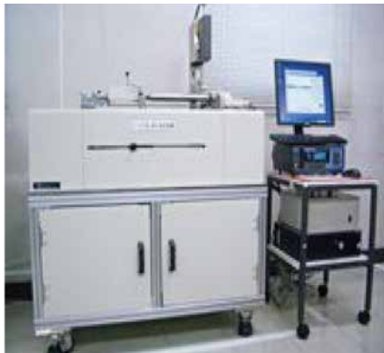
自動ロール外径、振れ測定装置 金属ロール・ゴムロールの外径と振れを同時に測定し、 外形・振れ・真直度を出力します。 【最小表示】0.001mm 【繰り返し精度】0.002mm (10 回測定時のσ値)
