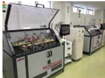
設備：パワーサイクル装置
