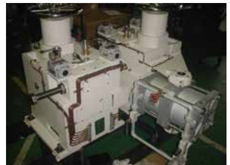
火力発電所納レジスタードライブ
