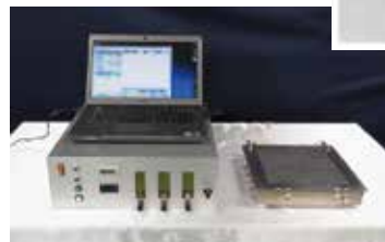
X線リフローシミュレーター （はんだ付中の溶融はんだの動きをX線で観察できます）
