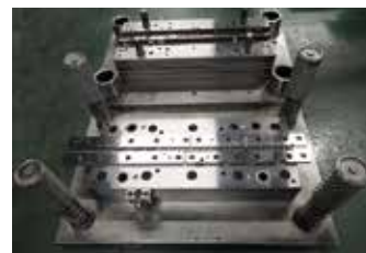
狭ピッチコネクタ用順送金型（52工程）
