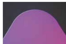
輪郭精度 \leq 100\text{nm} の超精密バイト
