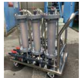
ワイン濾過機：透明ハウジングを採用した新製品です。
