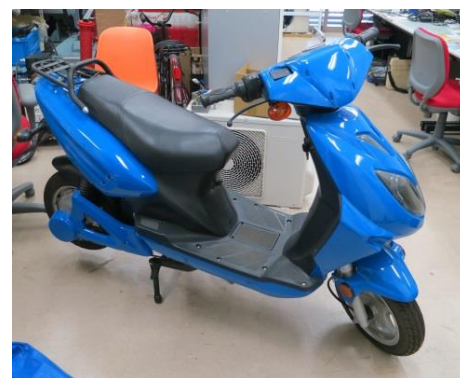
▲センサーレス・モータ・コントロール を搭載した電動自転車
