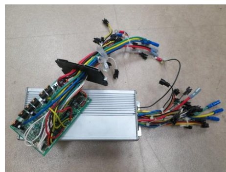
▲センサーレス・モータ・コントローラ (ケース概観と内部モジュール)
