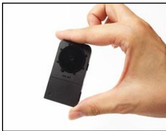
「人の動きを発電に」をキーワードに、歩くことにより発電し、個人 ID を送信できる「電池レス ID 送信装置」
